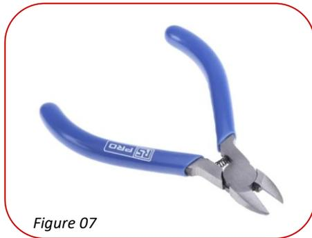
Le modèle de la figure 7, fabriqué en acier inoxydable avec les poignées recouvertes de plastique moulé, dispose d'une envergure de 160 mm et d'une coupe latérale capable de sectionner une épaisseur jusqu'à 1,2 mm.
