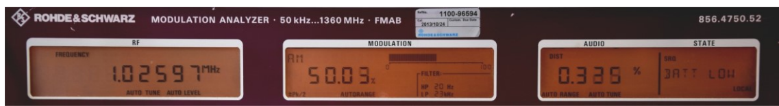
Figure 21 : THD pour un taux de modulation de 50 % : 0,33 %.
