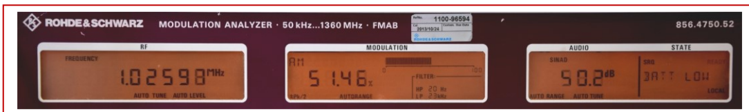
Figure 24 : rapport signal à bruit suivant SINAD pour un taux de modulation de 50 % : 50,2 dB.
