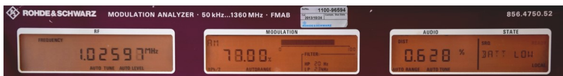
Figure 22 : THD pour un taux de modulation de 77 % : 0,63%.
