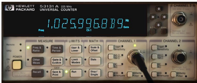
Figure 13 : contrôle de la précision de la fréquence.
