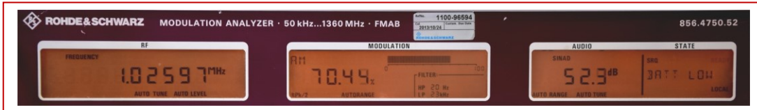
Figure 23 : rapport signal à bruit suivant SINAD pour un taux de modulation de 70 % : 52,3 dB.
