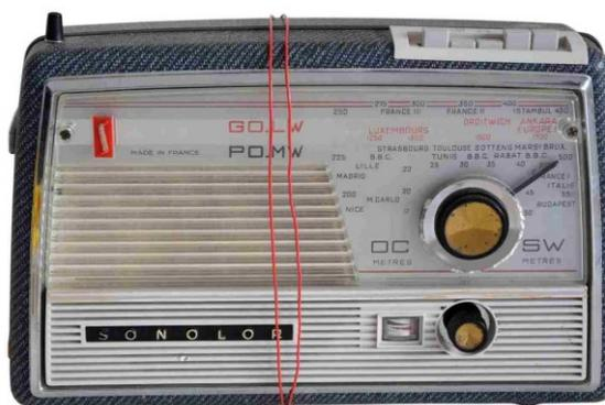
*Figure 64 : pour le cliché il a été choisi un fil rouge afin de bien montrer le principe. Un fil gris et fin permettrait d'éviter de rendre trop visible cette boucle de couplage formée ici de deux spires.*
