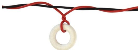
Figure 22 : torsader la ligne de couplage
