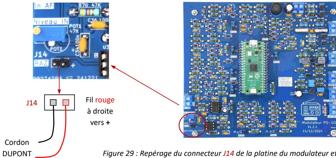
Figure 29 : Repérage du connecteur J14 de la platine du modulateur et du sens de raccordement du cordon DUPONT : fil rouge à droite vers le + de la sérigraphie.
