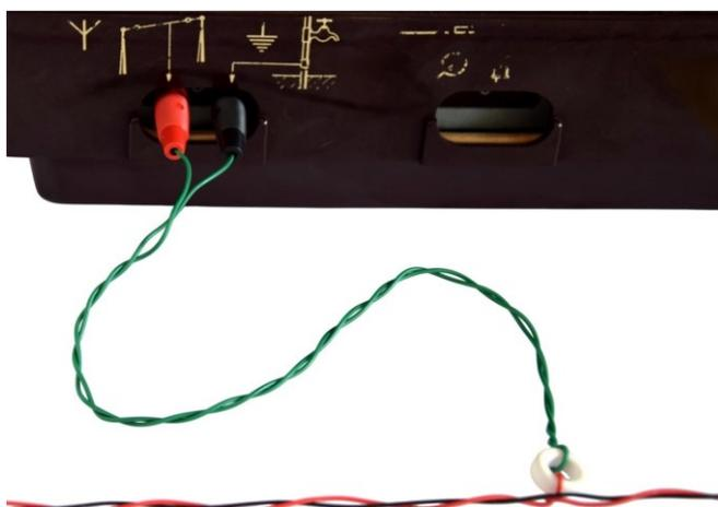
Figure 31 : exemple de raccordement de la boucle de couplage sur les bornes **Antenne** et **Terre** d'un récepteur TSF des années cinquante (Philips BF321A).
