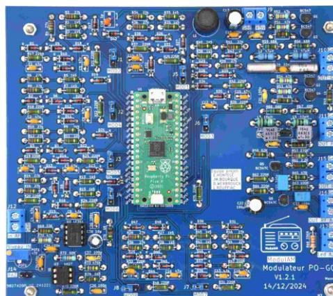
Figure 06 : la platine du modulateur (v1.2.1) une fois l'ensemble des composants implanté et soudés.
