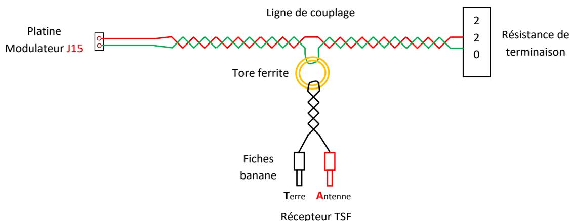
Figure 20 : schéma de principe de la ligne de couplage de test.
