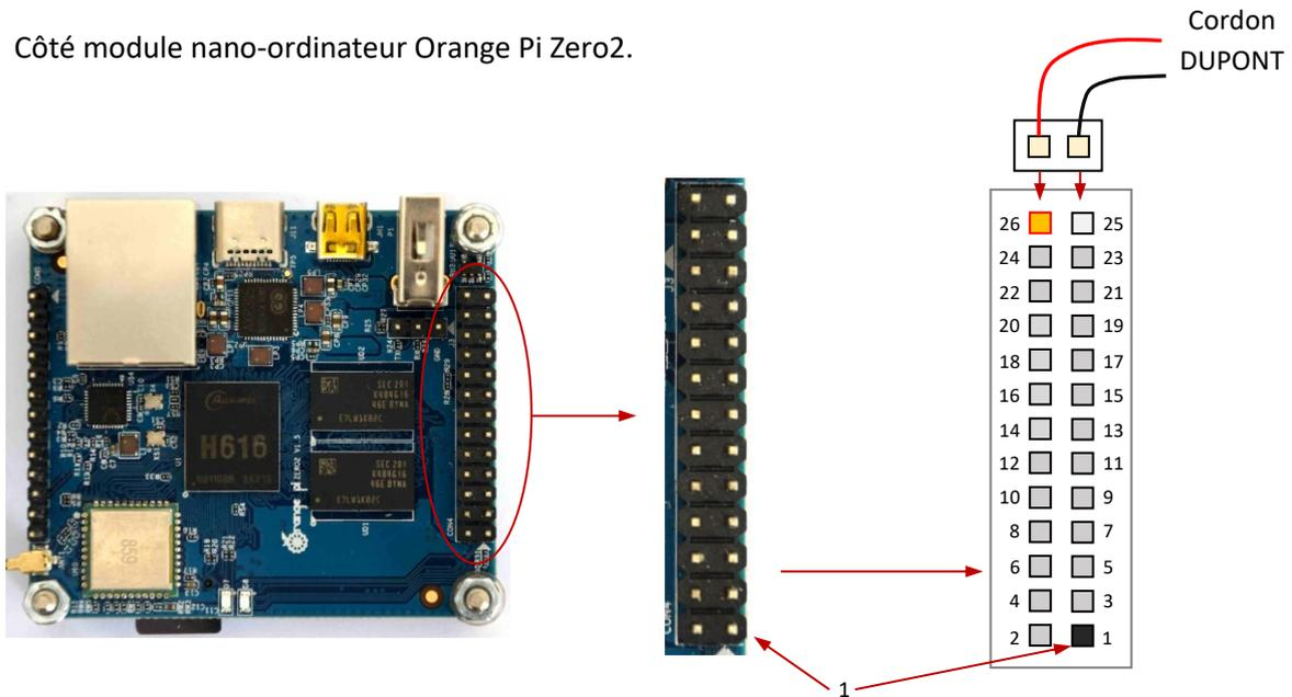
Figure 30 : Repérage des broches 25 et 26 du connecteur d'extension du module Orange Pi Zero2 et du sens de raccordement du cordon DUPONT : fil rouge à gauche.
