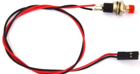
Figure 25bis : réalisation du cordon de commande de l'ARRÊT du système **ModulAM**, à l'aide de l'interrupteur à bouton poussoir.
