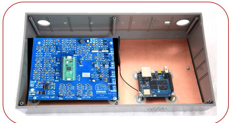
Figure 10 : position des modules une fois montés sur la plaque de fond.
