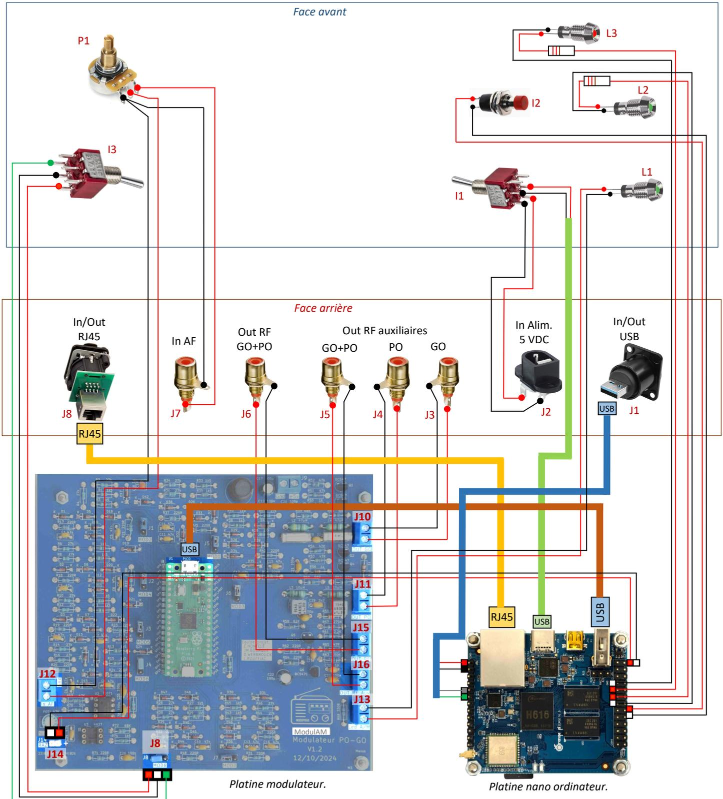
Figure 14 : plan général de câblage et d'interconnexion.
