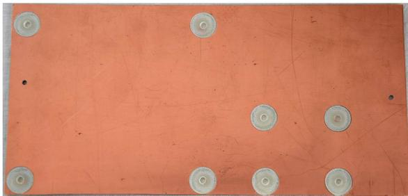
Figure 08 : plaque de fond usinée (voir plan d'usinage dans la partie 1 de cette documentation).
