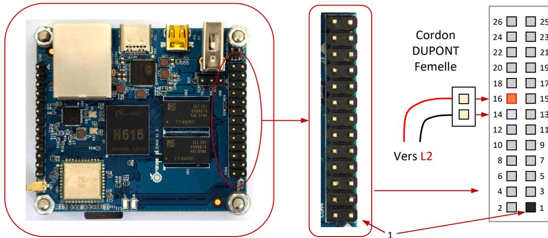
Figure 21 : Repérage des broches de raccordements du voyant led **L2** sur le connecteur d'extension 26 broches du nano-ordinateur Orange Pi Zero2.
