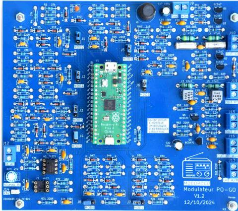
Figure 04 : Platine **ModulAM** équipée du processeur Raspberry Pico.
