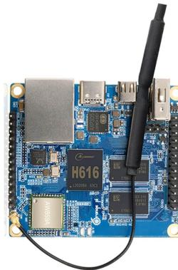
Figure 05 : Module nano-ordinateur Orange Pi Zero 2.
