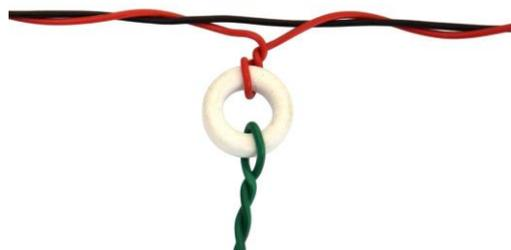
Figure IV-5 : effectuer une spire dans le tore ferrite
