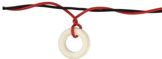
Figure IV-3 : torsader la ligne de couplage
