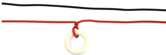
Figure IV-2 : effectuer une spire dans le tore ferrite
