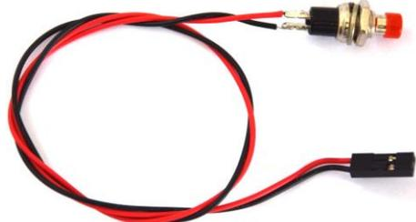
Figure IV-7 : réalisation du cordon de commande de l'ARRÊT du système **ModulAM**, à l'aide de l'interrupteur à bouton poussoir.
