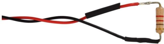
*Figure IV-4 : réalisation en cours du raccordement de la ligne de couplage avec la résistance de terminaison de 220  $\Omega$ .*
