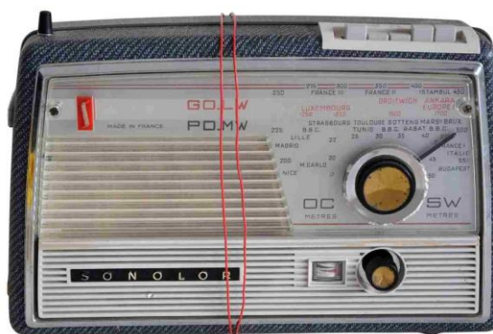
Figure VII-12 : pour le cliché il a été choisi un fil rouge afin de bien montrer le principe. Un fil gris et fin permettrait d'éviter de rendre trop visible cette boucle de couplage formée ici de deux spires.
