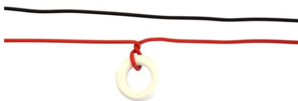
Figure IV-2 : effectuer une spire dans le tore ferrite
