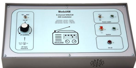
Figure II-05 : face avant du boîtier d'accueil supportant les commandes et signalisations.
