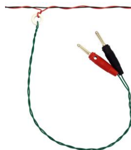
Figure IV-6 : ligne de couplage terminée
