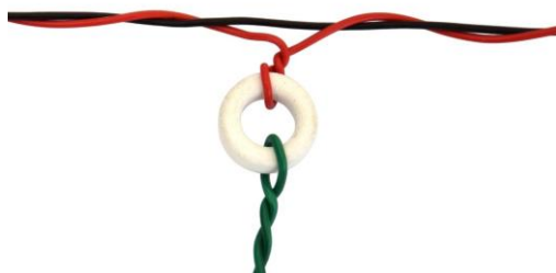
Figure IV-5 : effectuer une spire dans le tore ferrite
