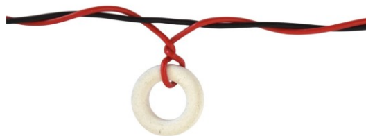
Figure IV-3 : torsader la ligne de couplage
