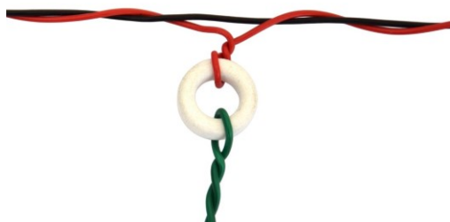
Figure IV-5 : effectuer une spire dans le tore ferrite
