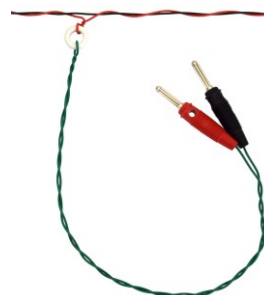
Figure IV-6 : ligne de couplage terminée
