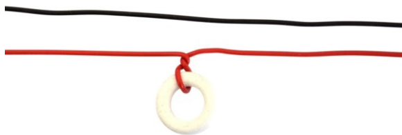
Figure IV-2 : effectuer une spire dans le tore ferrite
