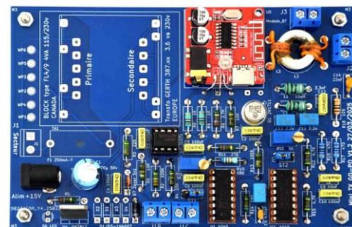
Niveau 2 : alimentation par une source externe de tension redressée de 15 à 30 VDC.
