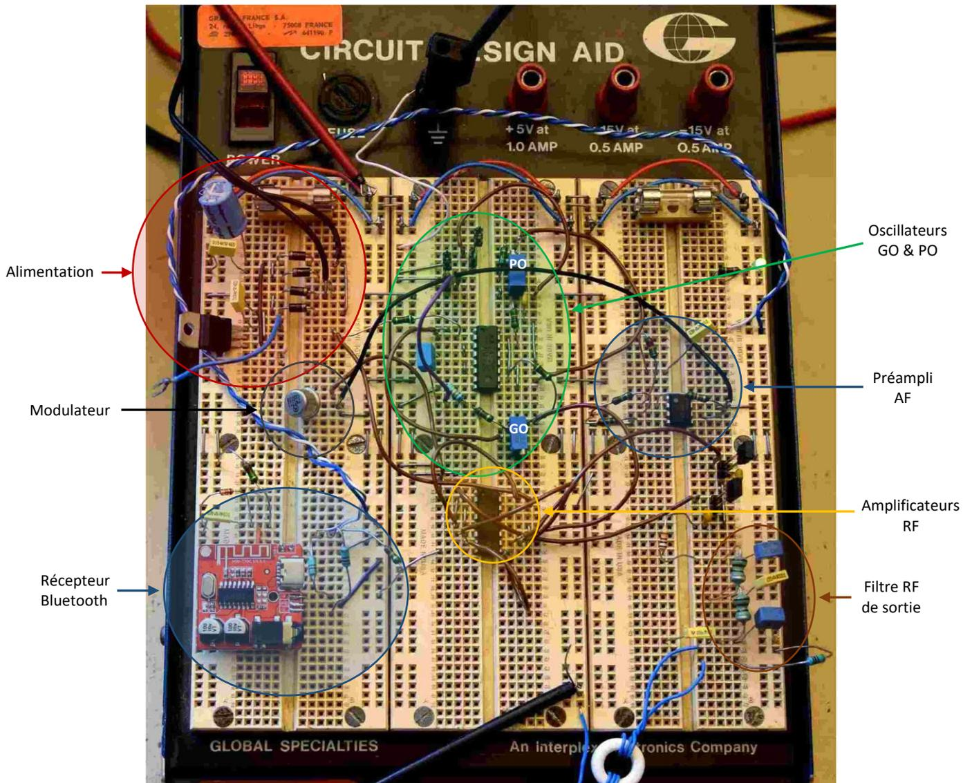
Maquette / prototype 1 réalisé sur une platine d'essai.
